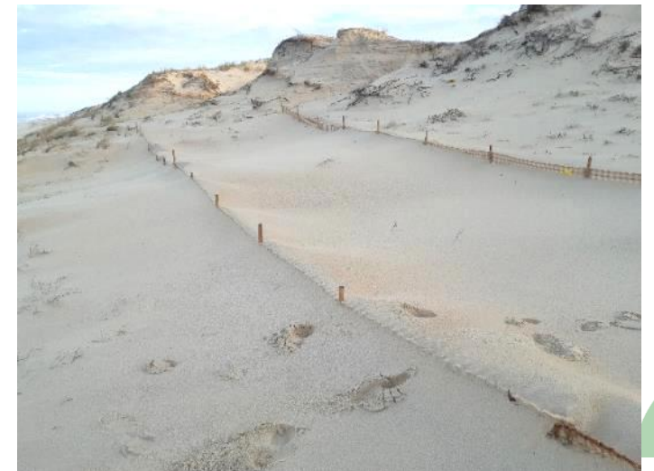
FR711 - Test de filets en jute (Lit-et-Mixe)
