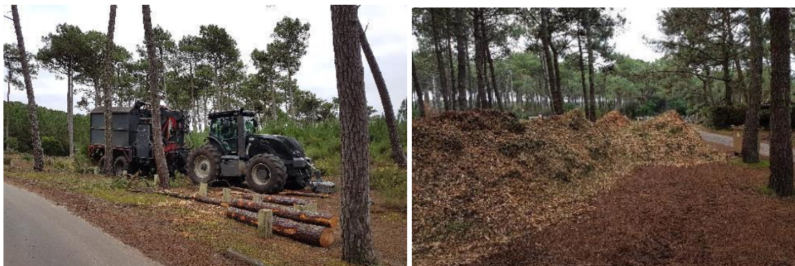
Figure 3: Broyeur et broyat récupéré pour être réutilisé sur les cheminements (C. Bouchet, ONF)
