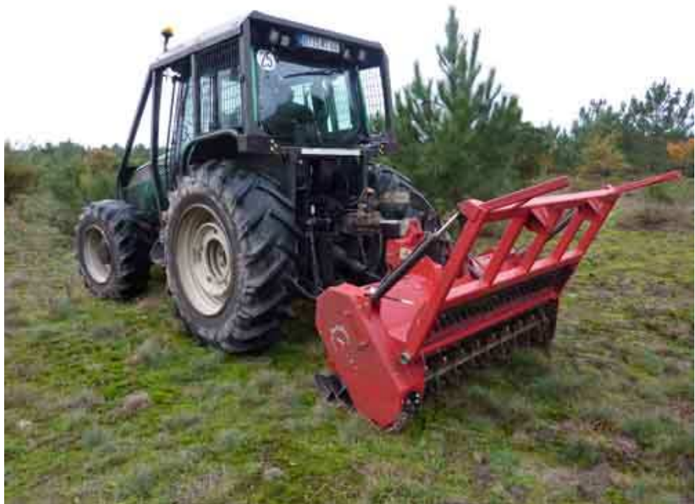
photo 2 : Traitement mécanique par broyage
