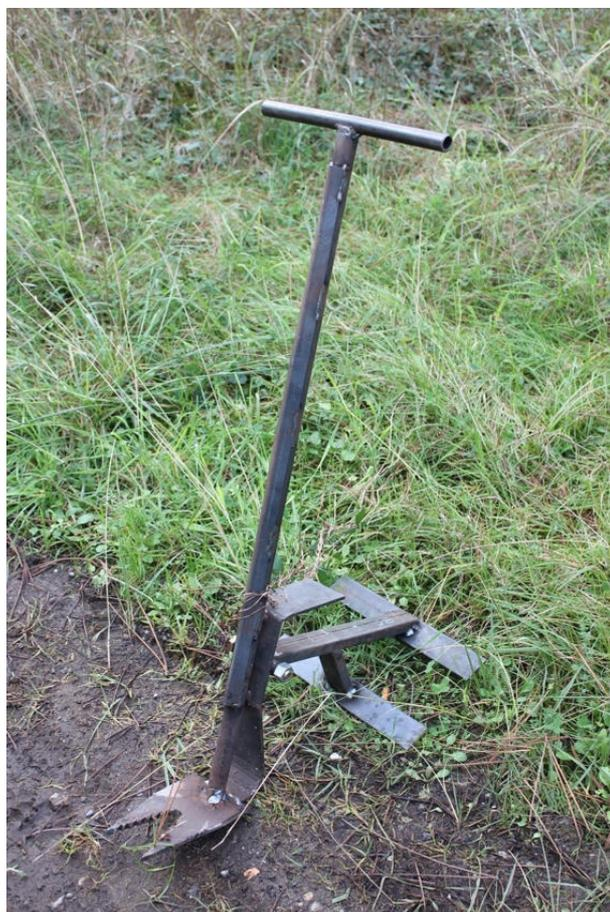
Deux vues du levier, ici dans sa version « améliorée », car il a été nécessaire de réaliser des échancrures dans le « V » afin de ne pas glisser sur les collets ou les souches. Les bases (fers plats doubles) permettent l'appui du levier avec un angle assez ouvert, ce qui donne une grande force avec le bras de levier correspondant.
